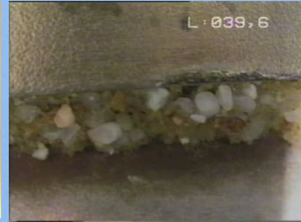
Saldatura assente
