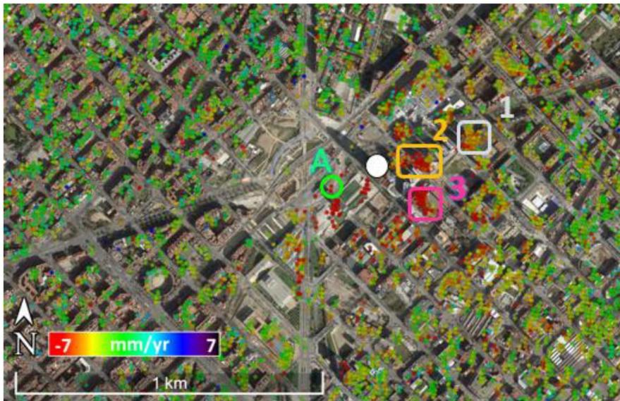
*Interferometria multi-temporale PS in area urbana per la misura di deformazioni indotte da abbassamento piezometrico eseguito per le esigenze costruttive di un sottopasso ad uso stradale (da Crosetto et al., 2018). Dati Sentinel 1.*
