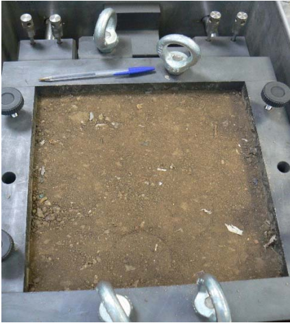
Figura 5: realizzazione del provino con costipamento tramite pestello direttamente all'interno della scatola di Casagrande (nello specifico, miscela misto cementata del progetto di bonifica della porzione non impermeabilizzata del I lotto della discarica "Maza" in Comune di Arco).
