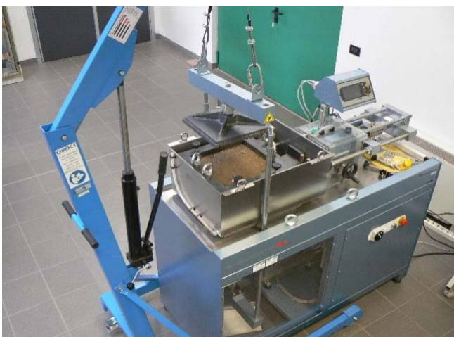
Figura 3: assemblaggio della prova con sistema di sollevamento dedicato.
