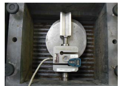
Figura 4: allestimento di un sistema di controllo dello sforzo orizzontale per una verifica metrologica direttamente in macchina.
